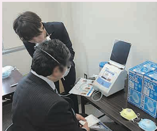
定量的に漏れ率を測定
